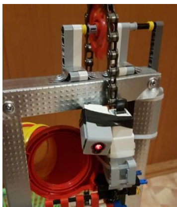
Рис. 1. Робот оснащен датчиком цвета.
