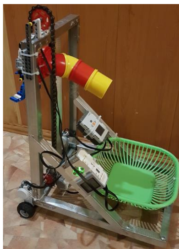
Рис. 4. Робот «Сборщик урожая», вид с боку.
